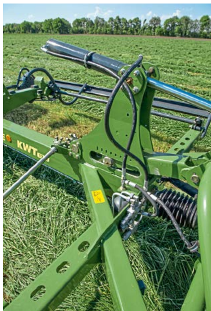
Vom Aushubzylinder wird das Öl in die Stickstoffblase geführt. Bei gefüllter Blase entlastet der Zylinder das Transportfahrwerk und überträgt das Gewicht auf die Kreiselräder.
