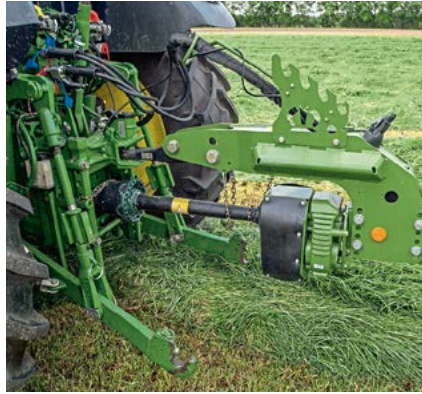
Die Maschine kann wahlweise unten oder oben angehängt werden. Die Deichsel ist dafür drehbar. Gegen Aufpreis gibt es auch einen Dreipunktbock.
