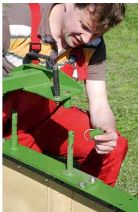
Die Arbeitstiefe wird einfach per Kurbel eingestellt. Auch das Schwadtuch kann in der Höhe über Distanzhülsen justiert werden.
