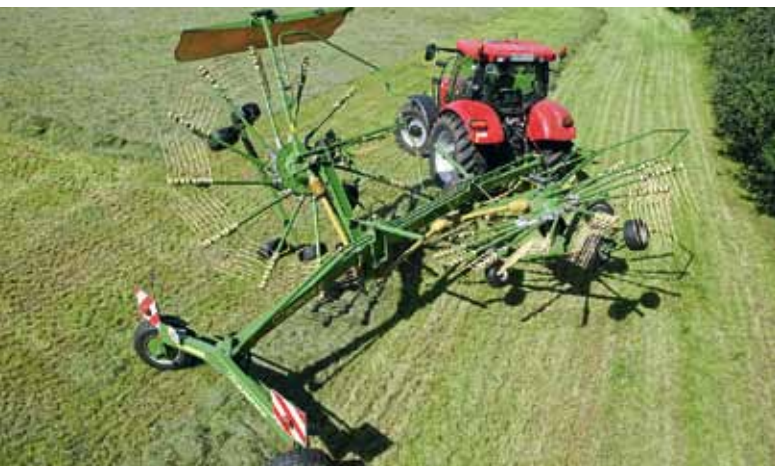
Dank des großen Lenkeinschlags ist man am Vorgewende schnell wieder in der nächsten Spur. Die Aushubhöhe der Kreisel reicht gerade aus.
