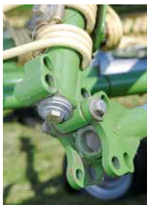
Zur Einhaltung der zulässigen Transporthöhe werden nicht ganze Zinkenarme entnommen, sondern drei der 14 Arme am Ende geklappt. Eine Tellerfeder im Arm hält dabei die Bolzenverbindung unter Spannung und damit spielfrei.
