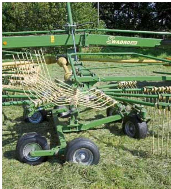
Zur Einhaltung der zulässigen Transporthöhe werden nicht ganze Zinkenarme entnommen, sondern drei der 14 Arme am Ende geklappt. Eine Tellerfeder im Arm hält dabei die Bolzenverbindung unter Spannung und damit spielfrei.
