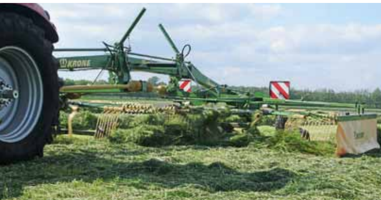
Der vordere Kreisel wirft mit der um 10 % höheren Drehzahl das Futter in die Bahn des zweiten Kreisels.
