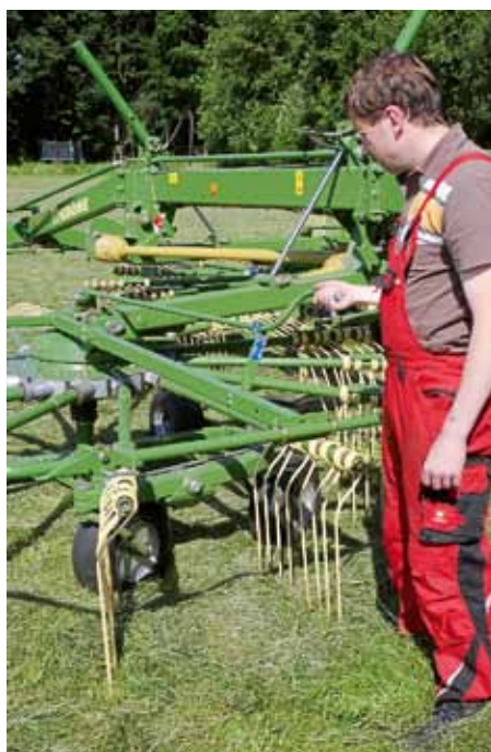
Die Arbeitstiefe wird einfach per Kurbel eingestellt. Auch das Schwadtuch kann in der Höhe über Distanzhülsen justiert werden.
